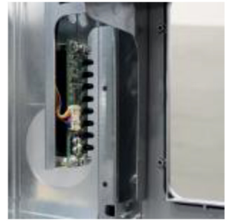
Fotocellen voor de herkenning van bekers tot 3 verschillende hoogtes
